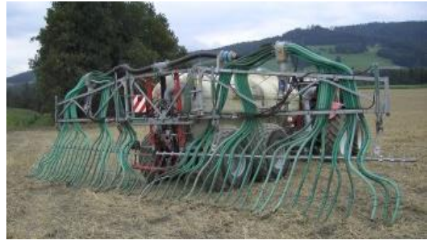
Abbildung 11: Eine bodennahe Ausbringtechnik flüssiger Wirtschaftsdünger reduziert Emissionen und bringt verbesserte Nährstoffeffizienz!
