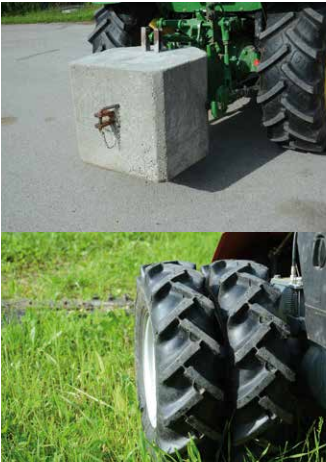
Abbildung 26: Ballastgewicht und Zwillingsbereifung reduzieren die Kippgefahr. (© Susanne Schönhart)
